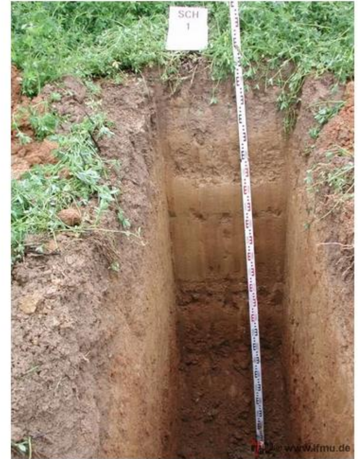
Bodenprofil eines Baggerschurfes
